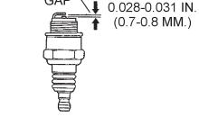
Figure 30. Spark Plug Gap
